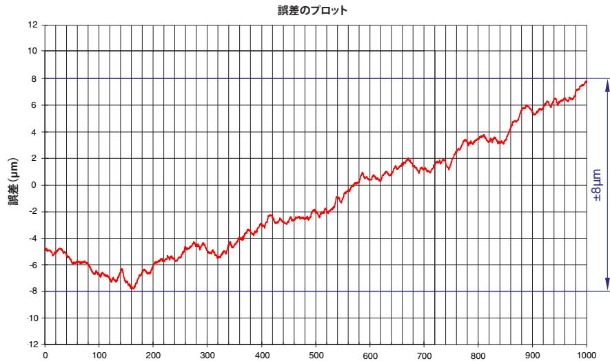
長さ 1000mm の RTLA50 スケールの精度テスト結果の例
