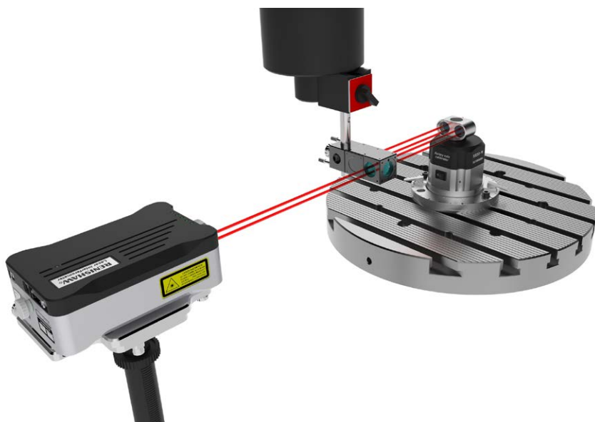
图1 使用XL-80作为激光基准对回转轴进行校准时的典型设定
