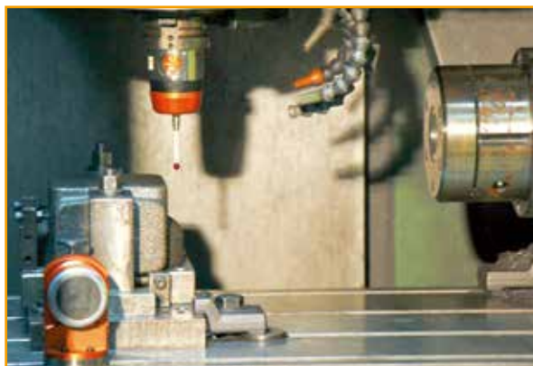
使用Primo Part Setter（工件测头）定位泵体铸件的基准边缘
