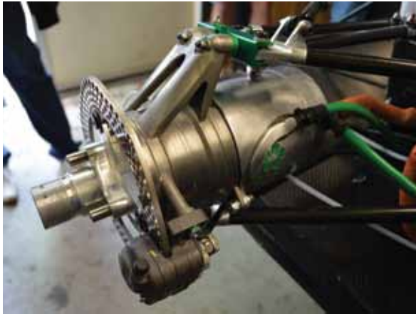
利用雷尼绍金属快速成型制造工艺生产出的钛合金轮架使得整车重量减轻了1.5 kg。
