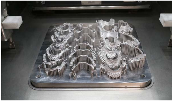
雷尼绍AM 400内部的RPD加工托盘
