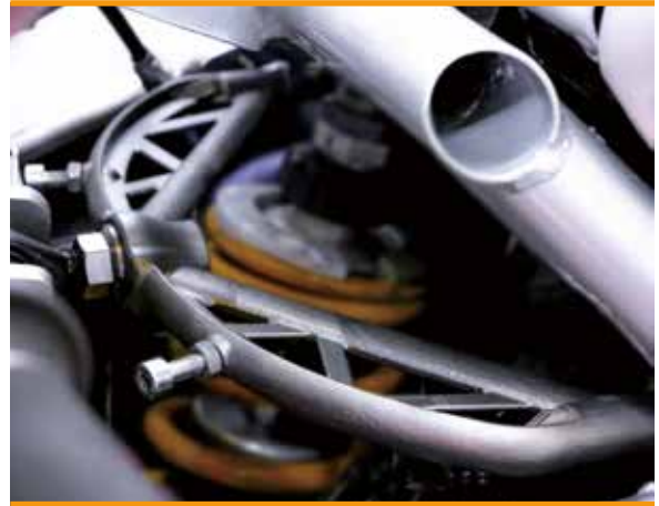
TransFIORmers摩托车上的金属3D打印一体式钛合金组件
