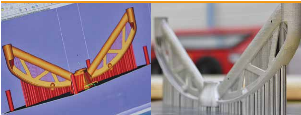
钛合金组件的CAD设计图及利用增材制造技术加工出的成品
