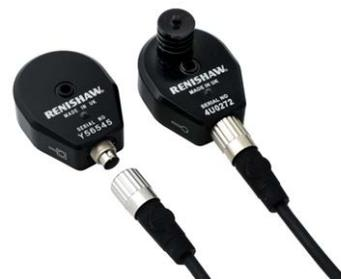
I sensori della temperatura dell'aria e del materiale sono due elementi separati e vengono forniti insieme ai relativi cavi di comunicazione. Ciascun cavo è dotato di un connettore filettato (femmina) da collegare al sensore e di un connettore maschio che va collegato nell'apposita presa visibile sul lato del sistema di compensazione XC.
