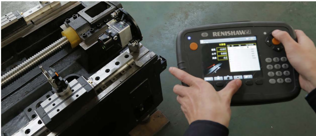
Le système laser d'alignement XK10 de Renishaw utilise la technologie de communication sans fil
