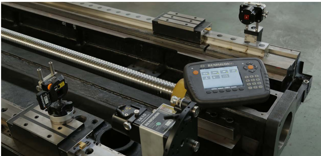
Utilisation du XK10 pour mesurer le parallélisme de deux rails de guidage
