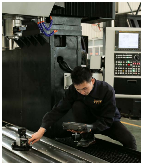
Utilisation du XK10 pour les mesures de perpendicularité
